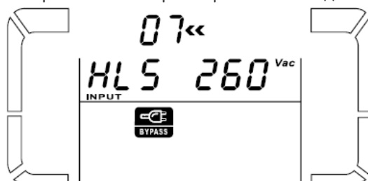
Рис. 4-7 Настройка диапазона напряжения Байпас (Примечание: изображение, выделенное пунктиром, мигает)
