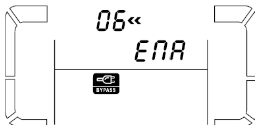
Рис. 4-8 Включение/выключение «Байпас» при выключенном ИБП (Примечание: изображение, выделенное пунктиром, мигает)
