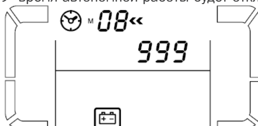
Рис. 4-6 Настройка режима автономной работы (Примечание: изображение, выделенное пунктиром, мигает)
